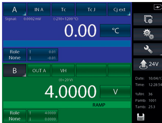
Fig. 60 - Función rampa activa
