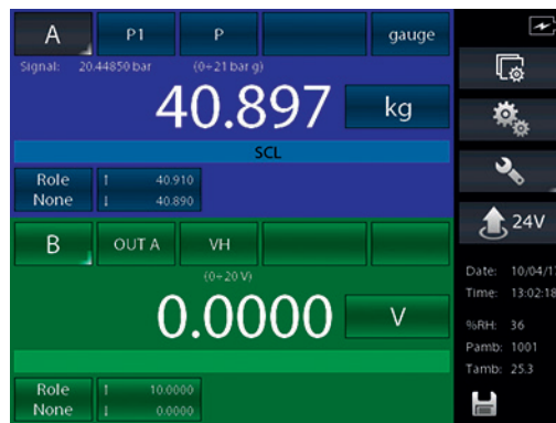
Fig. 69 - Canal con función de escalado activa
