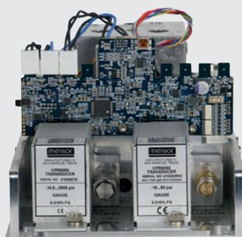
Módulo de presión SVR equipado con hasta dos sensores
