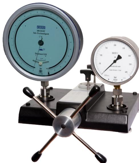
Ensemble d'étalonnage CPP4000-X avec manomètres de test comme étalon et instrument sous test
