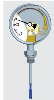
Les variations de la température ambiante agissant sur le boîtier sont compensées par un élément bimétal monté entre le mouvement et le tube manométrique.
