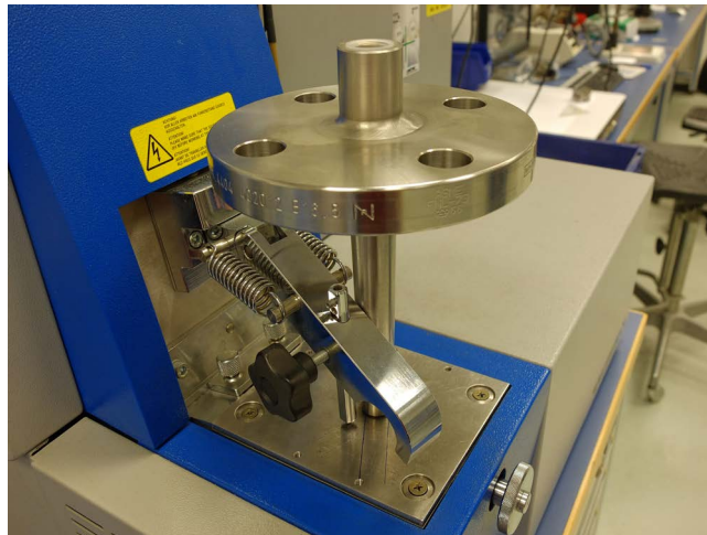
Prueba PMI: Análisis espectral de una vaina de brida modelo TW10
