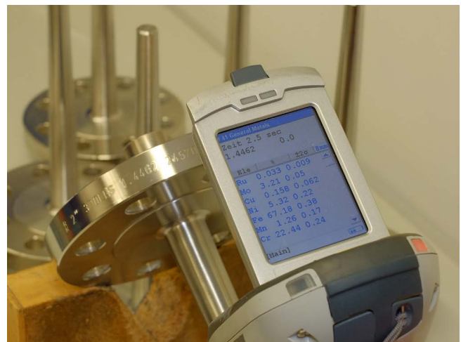
Prueba de PMI: Análisis de fluorescencia del bulbo de la vaina
