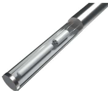
Nelle termoresistenze rivestite, la parte flessibile della sonda è costituita da un cavo rivestito in metallo con isolamento minerale (cavo MIMS). È composto da un rivestimento esterno in acciaio inox che contiene i conduttori interni isolati, incorporati in un composto ceramico ad alta densità. La resistenza di misura è connessa direttamente ai conduttori interni del cavo.
