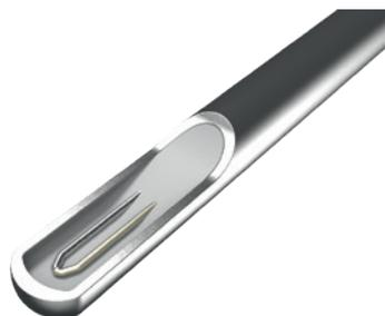
Nelle termocoppie rivestite, la parte flessibile della sonda è costituita da un cavo rivestito in metallo con isolamento minerale (cavo MIMS). È composto da un rivestimento esterno in metallo, che contiene i conduttori interni isolati, incorporati in un composto ceramico ad alta densità. Le termocoppie rivestite, grazie alla loro flessibilità e ai loro diametri ridotti, possono essere impiegate in posizioni di difficile accesso.
