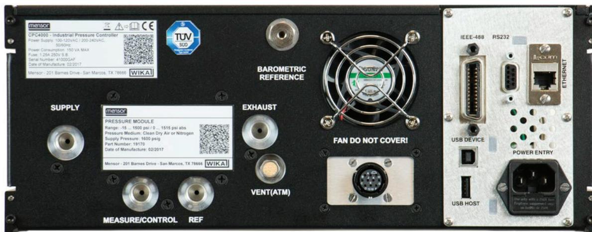
Рисунок 5.4 А – Задняя панель
