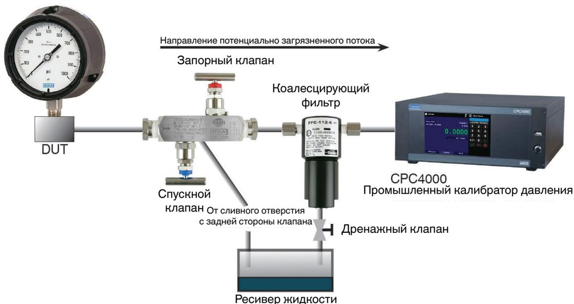
Рисунок 8.6.2 – Дополнительное оборудование защиты от загрязнений
