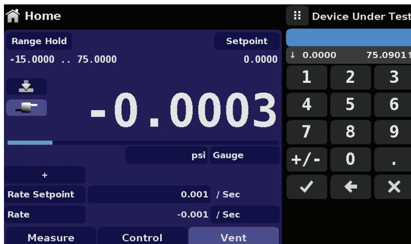
Рисунок 8.6.3-С - Давление DUT для выполнения процедуры продувки
