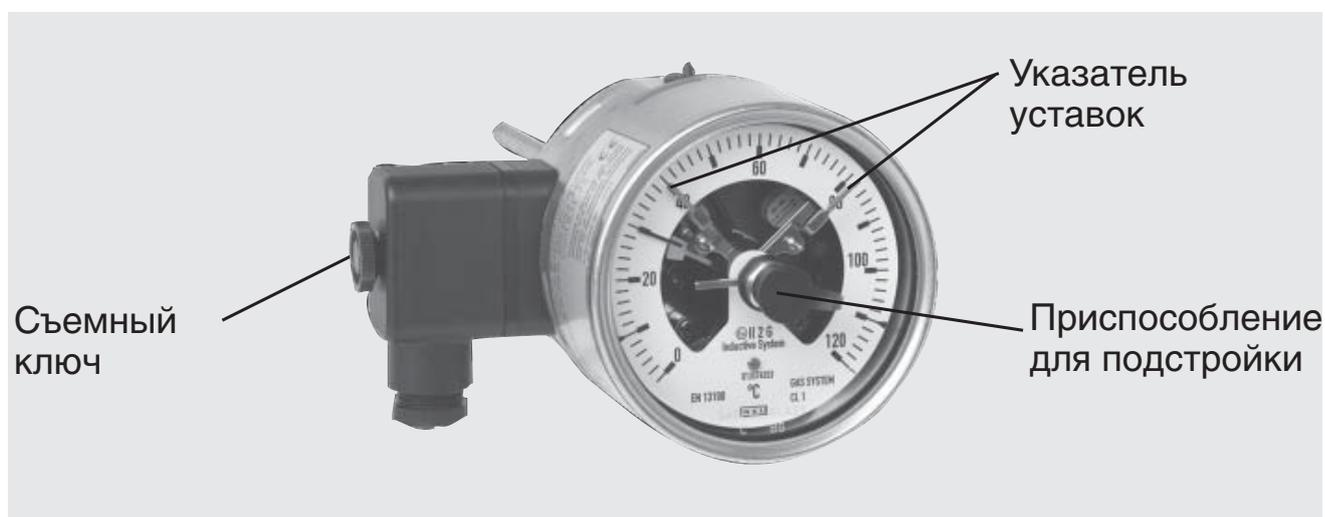
специального ключа (входит в комплект, закреплен на клеммной коробке). Настройка уставок может быть произведена во всем диапазоне прибора, однако, исходя из соображений точности переключения и долговечности работы механизма, уставки должны настраиваться в пределах 10 % ... 90 % диапазона измерений.
