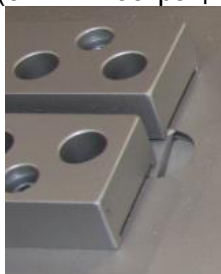
Иллюстрация 5: Зарубка между прижимной планкой и тыльной стороной
